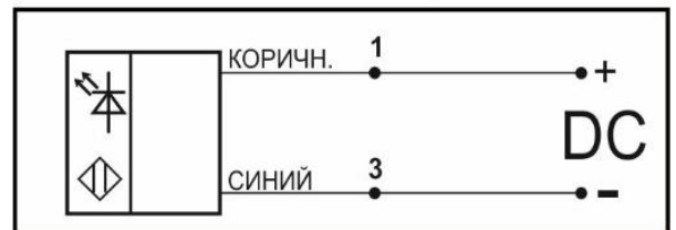
Схема соединения оптического излучателя
